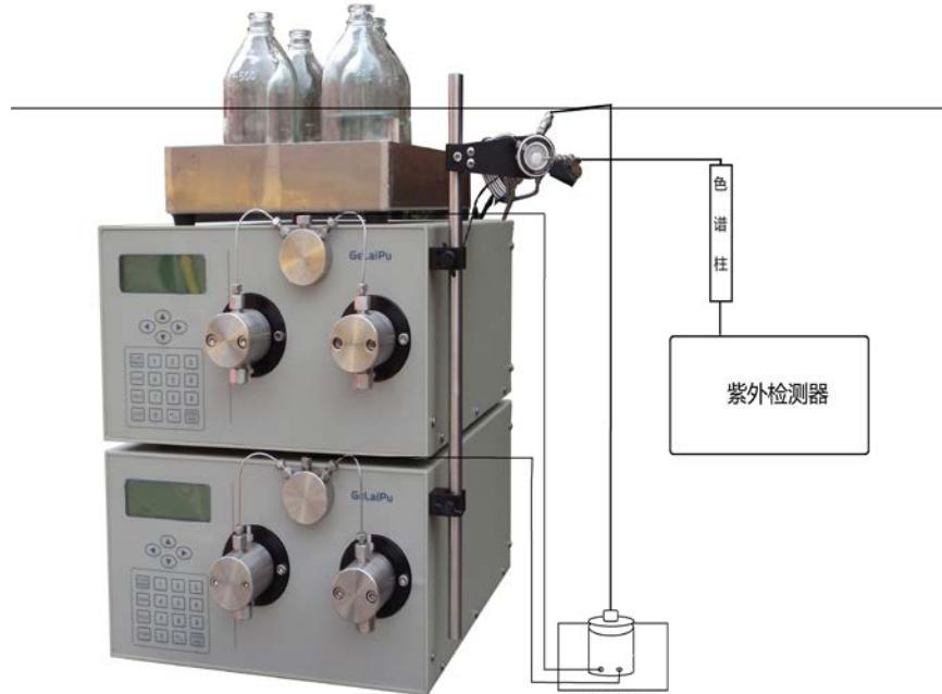
圖 9 高壓梯度液路連接示意圖
