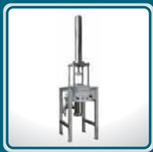
动态轴向压缩系统 DYNAMIC AXIAL COMPRESSION COLUMN
